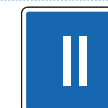
E.5.3 Höchstzahl der Fahrzeuges die auf der Seite der Wasserstraße, auf der das Tafelzeichen steht, nebeneinander stillliegen dürfen. Ziffern nach Ihren Angaben.
