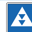
E.5.6 Liegestelle für Fahrzeuge der Schubschiffahrt, die die zwei blauen Lichter nach § 3.14 Nr.2 oder die zwei blauen Kegel nach § 3.32 Nr.2 führen müssen.
